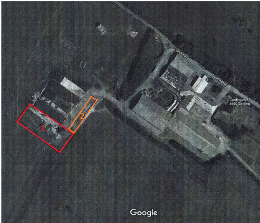
Figur 1: Placering af affaldsforbrændingsslagge. Der lægges slagge ud på det røde areal (1) til plansiloen, på det orange areal (2) til vendepladsen. Luftfoto fra situationsplan.
